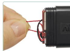
Для замены батарейного блока отключите разъём от платы устройства. Потяните петлю и извлеките блок батарей. Вставьте новый батарейный блок, подключите разъём. Активируйте маяк 5-ти кратным нажатием кнопки SOS.
